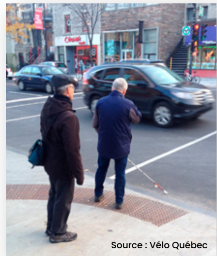
Figure 6 : Bande podotactile permettant de repérer le début et la fin du passage piéton
